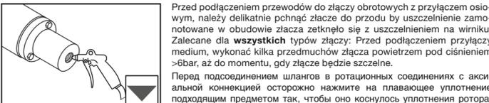
Przed podłączeniem przewodów do złączy obrotowych z przyłączem osiowym, należy delikatnie pchnąć złącze do przodu by uszczelnienie zamontowane w obudowie złącza zetknęło się z uszczelnieniem na wirniku. Zalecane dla wszystkich typów złączy: Przed podłączeniem przyłączy medium, wykonaj kilka przedmuchów złącza powietrzem pod ciśnieniem >6bar, aż do momentu, gdy złącze będzie szczelne.
