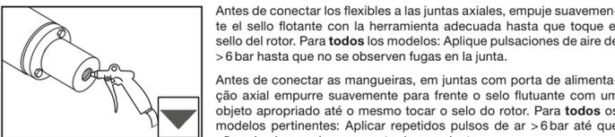
Antes de conectar los flexibles a las juntas axiales, empuje suavemente el sello flotante con la herramienta adecuada hasta que toque el selo del rotor. Para **todos** los modelos: Aplique pulsaciones de aire de > 6 bar hasta que no se observen fugas en la junta.
