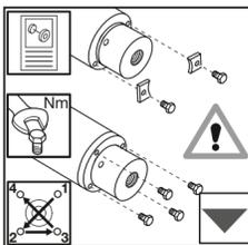
Nettoyer l'alésage de bout de broche ou le joint tournant sera installé. Lubrifier légèrement l'alésage de la broche pour les rotors lisses.
