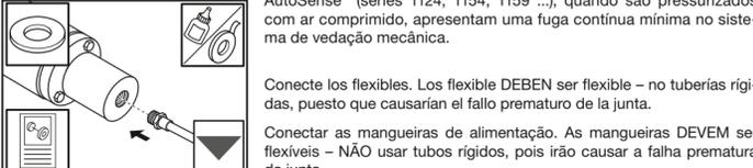
Colocar y conectar los flexibles sin tensiones ni pliegues.
