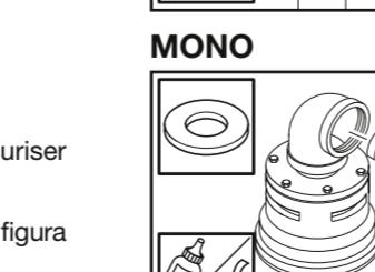
Visser et rendre étanche le flexible qui convient. Aucun tuyau rigide ! **Option :** Monter les flexibles avec la bride SAE, y compris le joint torique fornito, après le montage du joint tournant.
