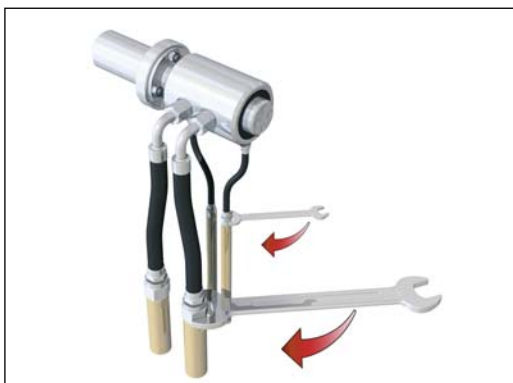
Fig. 4: Tubi flessibili deviati di 90°
