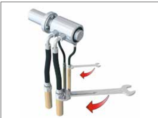
Abb. 4: Schläuche mit 90° Bogen anschließen
