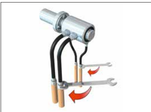
Abb. 5: Schläuche mit geradem Anschluss anschließen
