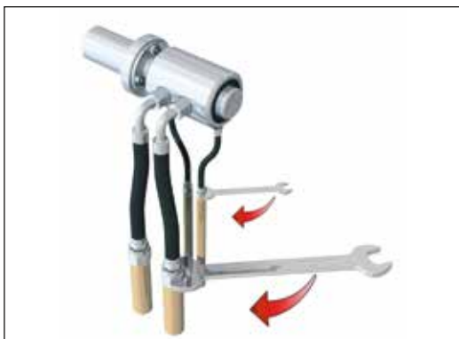
Рис. 4: Шланги проведены под углом в 90°
