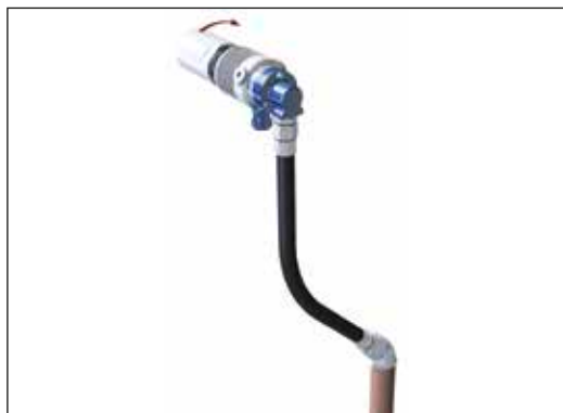
Fig. 6 : Raccorder les flexibles de manière à ce qu'ils soient orientés vers le bas
