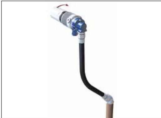
Les tuyaux d'alimentation du fluide doivent être flexibles. Pendant l'utilisation, le flexible d'alimentation empêche l'apparition d'efforts latéraux sur les roulements à billes du joint tournant.
