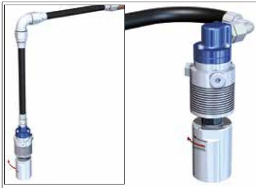
Lorsque les flexibles partent verticalement depuis les joints tournants et qu'ils doivent être déviés de 90°, alors raccordez les flexibles comme indiqué.
