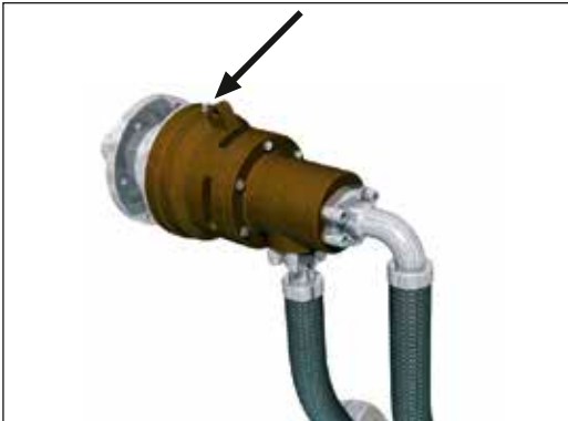
Abb. 8: Fettpresse aufsetzen und schmieren
