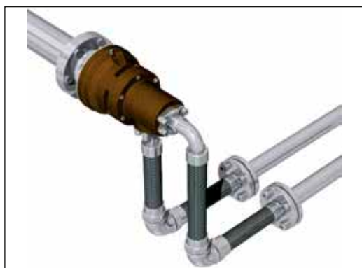
Rys. 5: Przewody giętkie ułożone pod kątem 90°
