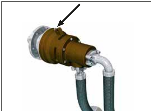
Rys. 8: Przystaw smarowniczkę do gniazda smarowego
