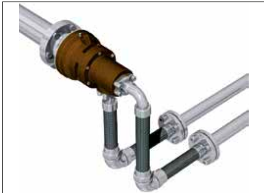
Рис. 5: Присоединение шлангов под углом в 90°
