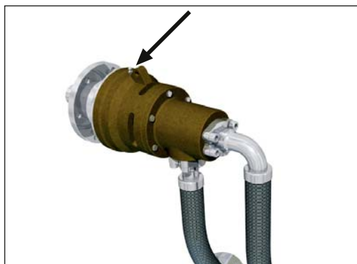
Fig. 8: Inserte la pistola de engrase para relubricar.
