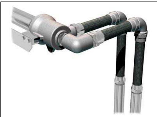
図 7 : 水平方向からのホース接続
