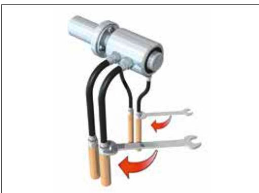
Abb. 5: Schläuche mit geradem Anschluss anschließen
