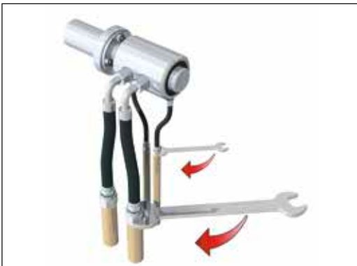
Abb. 4: Schläuche mit 90° Bogen anschließen
