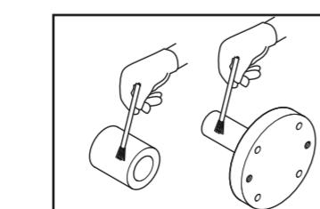
Avant la mise en place, graisser légèrement le joint tournant et la douille.
