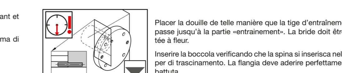
Placer la douille de telle manière que la tige d'entrainement dépasse jusqu'à la partie «entrainement». La bride doit être montée à fleur.
