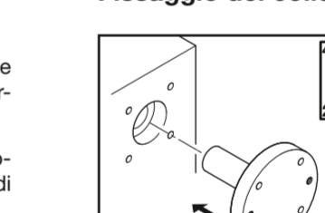
Sécuriser le joint tournant en fixant la bride avec les vis. Effectuer le vissaggio en croisant.
