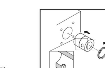
Installer la douille conformément aux préconisations (plan de **DEUBLIN**) dans le cylindre et, si nécessaire, la fixer avec un circlips (si existant).
