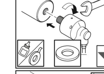
In caso di utilizzo di un nippolo di drenaggio **DEUBLIN**, inserire lo stesso a pressione nel foro in posizione a ore 6 e convogliare la linea di drenaggio in atmosfera.
