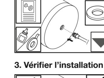
Raccorder le flexible d'alimentation. Collegare il tubo di alimentazione.
