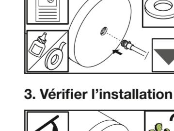
Pousser délicatement l'ensemble joint flottant dans le logement du corps jusqu'à la butée. Ré-installer le couvercle machine avec le corps du joint tournant. Eviter les chocs qui pourraient endommager les faces d'étanchéité. S'assurer que la face d'étanchéité du rotor et celle du corps soient parallèles.
