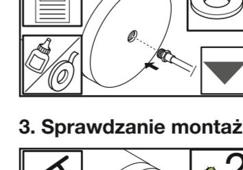
Wyczyść powierzchnie oznaczone strzałkami i nasmarować je lekkim olejem maszynowym. Oczyszczenie powierzchni, указаные стрелками и смажьте их с помощью машинного масла.
