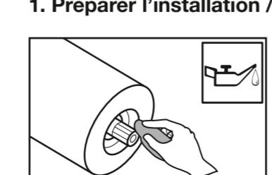
**Broches avec tirant:** Nettoyer le tirant et son logement. Vérifier l'état de l'extrémité (polygone) du tirant et si nécessaire le remplacer. Lubrifier le tirant avec de l'huile de la machine.
