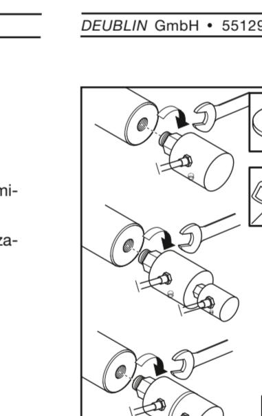
Installer et visser le Joint Tournant **DEUBLIN** sur l'arbre de la machine avec du PTFE ou un joint d'étanchéité.
