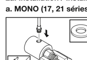
Raccorder et étancher le flexible adapté avec du PTFE ou similaire. Pas tuyaux rigides!
