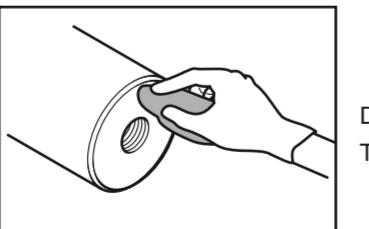
Dokładnie wyczyść końcówkę wału. Тщательно очистить посадочный конец вала.
