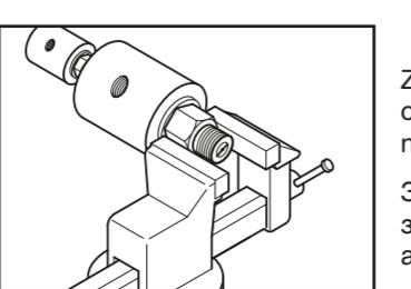
Zamocuj złącze obrotowe DEUBLIN w imadle, wyłącznie za część rotoru pokazaną na rysunku. **Uwaga!** Zwrócić uwagę aby nie uszkodzić aluminiowej obudowy.
