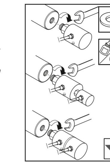
Enroscar la Junta Rotativa DEUBLIN en el eje de la máquina y sellar con sellante, cinta de PTFE o tórica.
