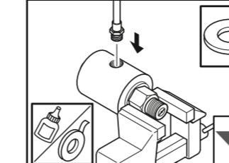
Montar un tubo flexible apropiado con sellante o PTFE. No utilice tuberías rígidas.
