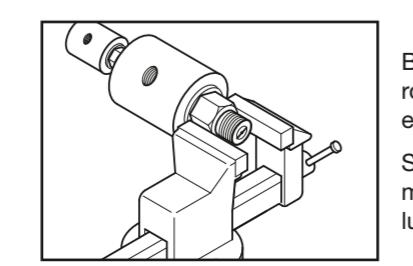
Bloquer le joint tournant dans un étau **UNIQUEMENT** par le rotor comme indiqué. **Attention:** Ne pas endommager le corps en aluminium.
