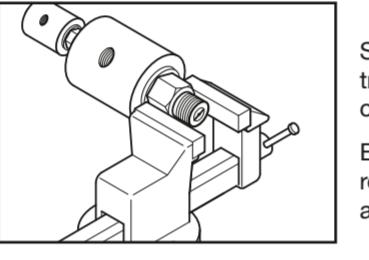
Sujetar la junta rotativa sólo por el rotor al tornillo banco de trabajo, como se muestra en la imagen. **Atención:** no dañar el cuerpo de aluminio
