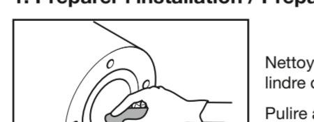
Nettoyer le logement dans le cylindre. Le logement dans le cylindre doit être propre et sans bavure.
