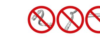
Poser e raccorder les flexibles sans tension, sans torsion et sans courbures exagérées.
