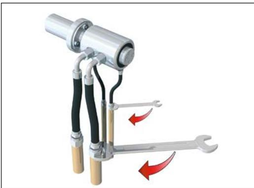
Abb. 4: Schläuche mit 90° Bogen anschließen
