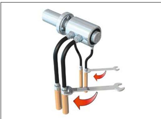
Abb. 5: Schläuche mit geradem Anschluss anschließen
