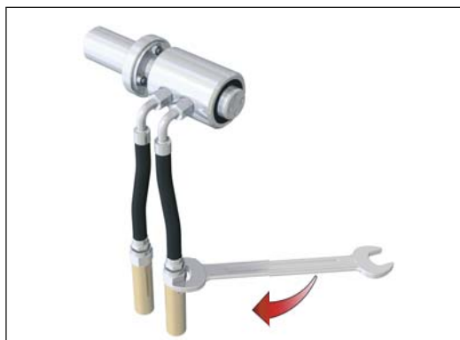
Abb. 6: Schläuche mit 90° Bogen anschließen
