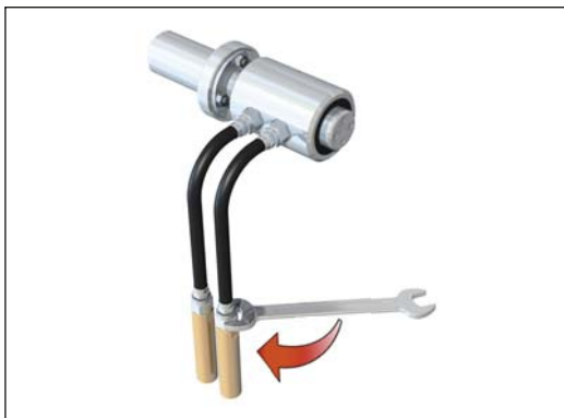
Abb. 7: Schläuche mit geradem Anschluss anschließen
