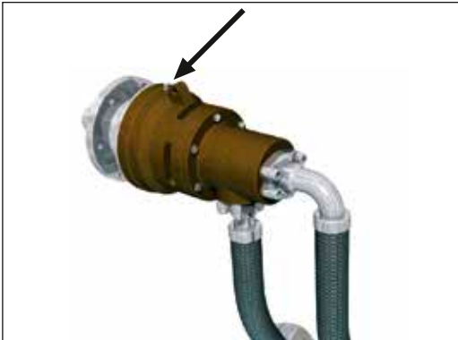
Fig. 8 : Utiliser un pistolet graisseur pour pour le graissage
